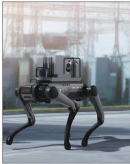
视源股份推出的 X7 是一款工业级高性能四足机器人,目标是替代人在危险、恶劣的场景中执行巡检类任务。X7 采用高性能电驱动关节与自适应步态算法,可稳定穿越 35° 陡坡、台阶、石板路、沙石、草地等复杂地形。
