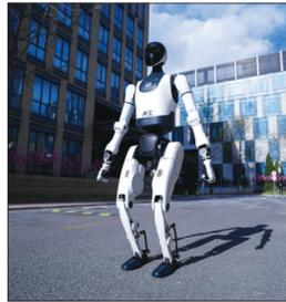
2025 年,北京人形机器人创新中心的新一代机器人“天工 2.0”完成了从“最能跑”到“最好用”的升级,“天工 2.0”搭载双电池快换电系统,突破带电设备电池热插拔换电,实现了首个工业级机器人永续作业能力。其配合多工况能耗控制技术,具备远超前代的续航能力,综合能效指标达到国际领先水平。在作业性能方面,“天工 2.0”具备工业级上肢负
