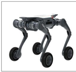
云深处“山猫”全地形机器人,整机重量为 30kg,负载重量为 12kg。“山猫”机器人能够攀爬 80cm 高台,以 5m/s 高速移动,上下 22cm 连续台阶,具备灵巧的身形和强悍的多地形适应能力。
