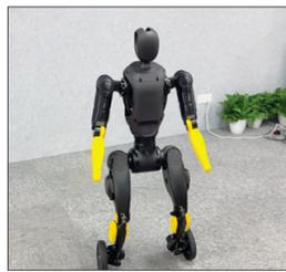
灵犀 X2-N 采用了“轮足二相腿”结构,该设计使机器人能够在轮式滑行与足式步行两种模式之间实现无缝切换,既保留了轮式移动的高效性,又具备足式结构应对复杂地形的强大适应力——无论是台阶、斜坡还是单边桥等障碍,均可轻松跨越。
