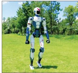
宇树科技发布的新款人形机器人 R1,实现了轻量化设计,整机重约 25kg,拥有 26 个关节数量,其中,双腿 12 个关节、腰部 2 个关节、手臂共 10 个关节、头部 2 个关节。
