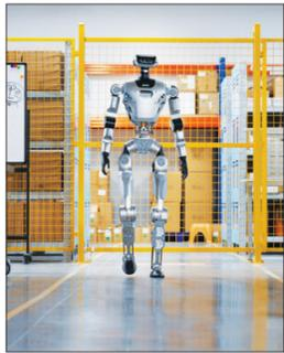
逐际动力推出的全尺寸通用机器人 LimX Oli,身高165cm,拥有31个机身自由度(不含末端执行器),以通用构型设计、模块化软硬件结构与持续完善的工具链开发系统,全面支持从算法研发到系统部署的各阶段工作。
