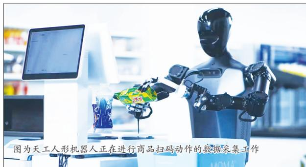
图为天工人形机器人正在进行商品扫码动作的数据采集工作
