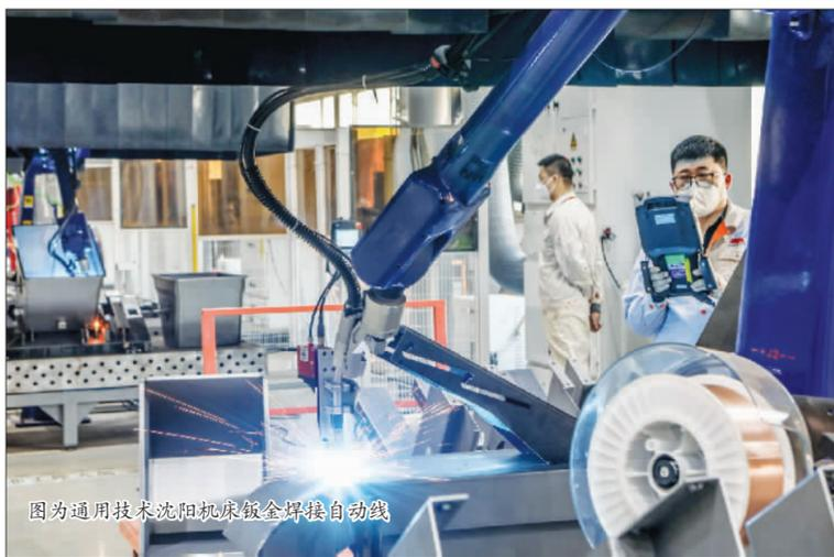
图为通用技术沈阳机床钣金焊接自动线
