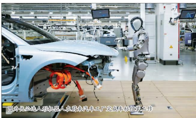
图为优必选人形机器人在蔚来汽车工厂完成车标组装工作
