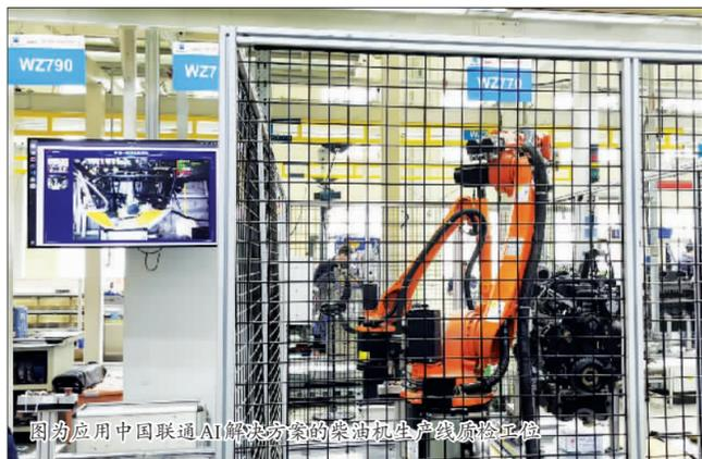
图为应用中国联通AI解决方案的柴油机生产线质检工位
