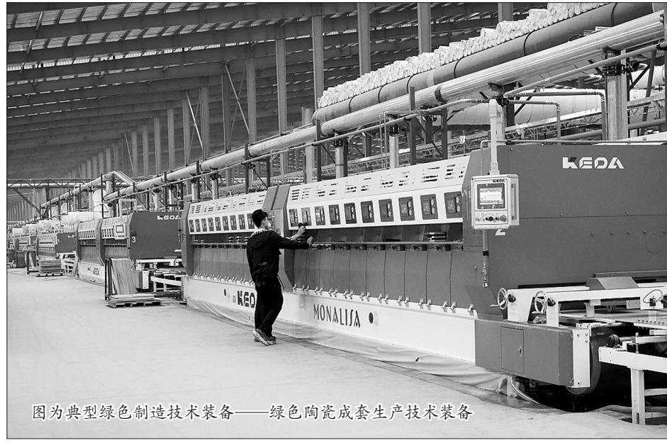
图为典型绿色制造技术装备——绿色陶瓷成套生产技术装备
