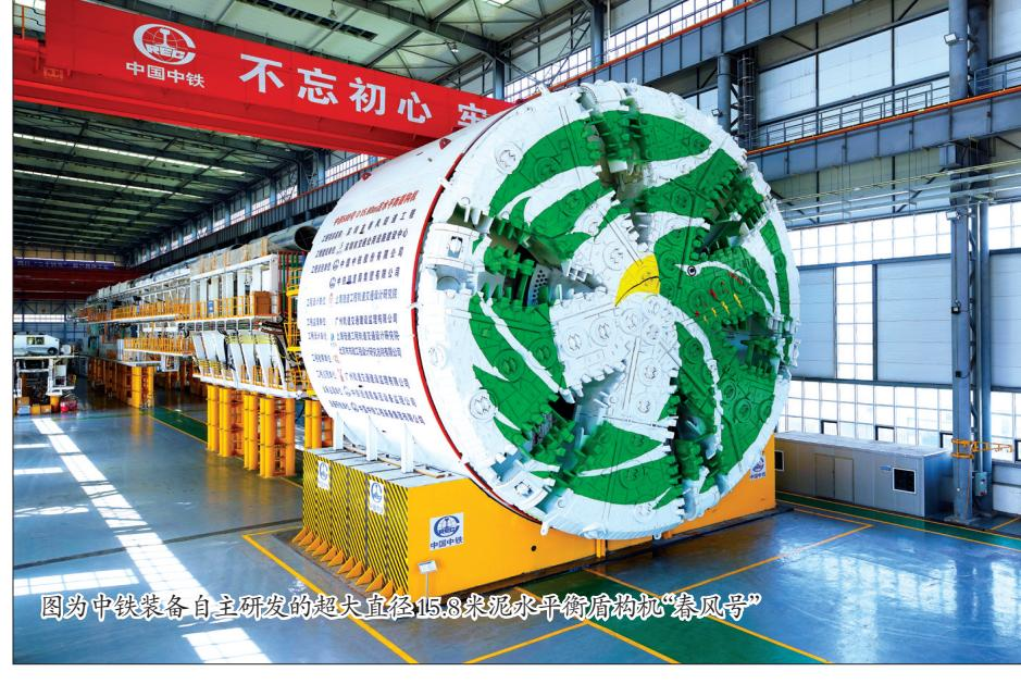
图为中铁装备自主研发的超大直径15.8米泥水平衡盾构机“春风号”
