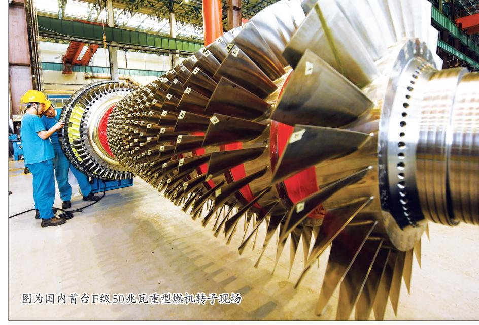
图为国内首台F级50兆瓦重型燃机转子现场
