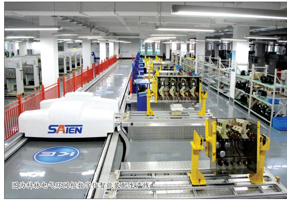
图为科林电气环网柜数字化智能装配生产线
